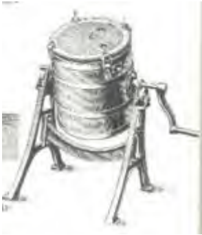
Ouderwetsse tuimelkarn die met handkracht werd aangedreven. Voorloper van de karn zoals die later in de zuivelfabrieken in gebruik was
