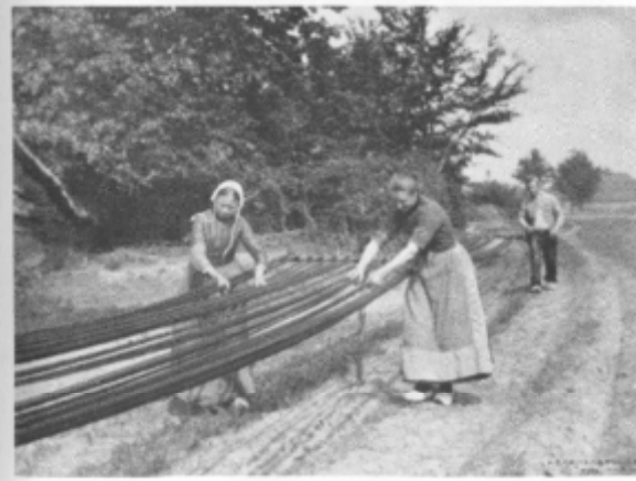
Op het platteland bleef de huisindustrie nog heel lang bestaan. Hier zijn vrouwen bezig met het zogenaamde 'kettinglijmen' ± 1900.
